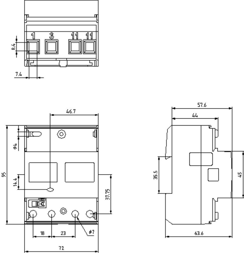
Fig. 2-16 Meter dimensions
