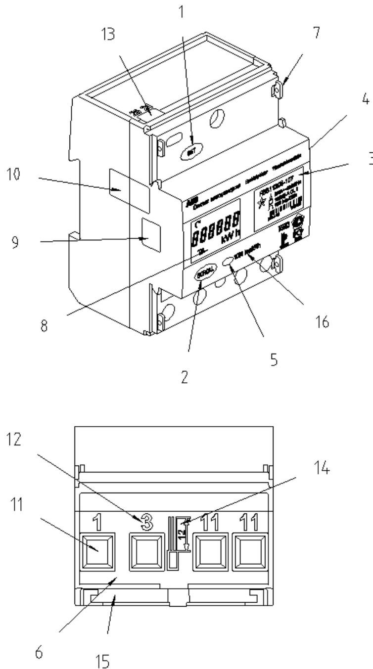
*Fig. 2-1 Meter parts*
