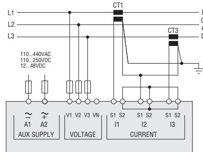
Connessione trifase senza neutro mediante TV
