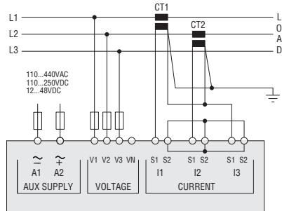
Connessione trifase con neutro mediante TV
