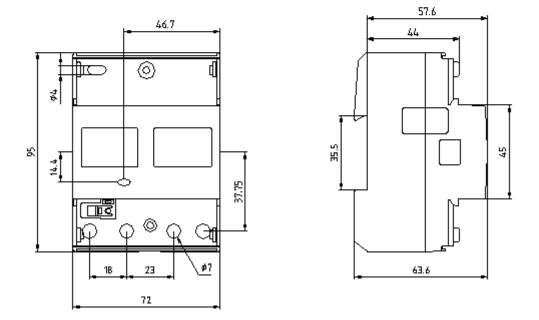
Fig. 2-16 Meter dimensions
