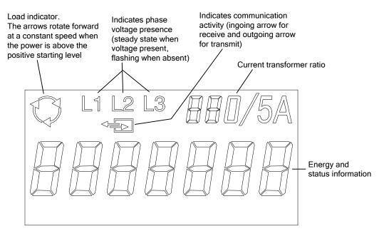
Fig. 2-5 ODIN meter LCD
