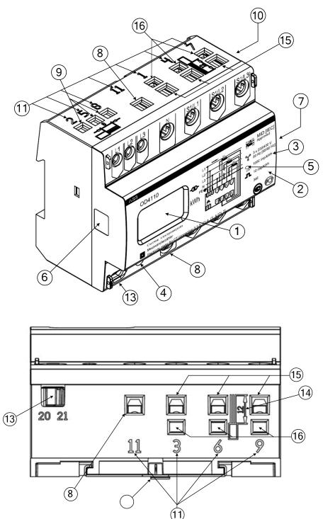
Fig. 2-1 Meter parts
