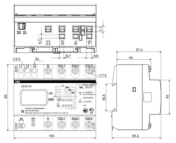
Fig. 2-13 Meter dimensions
